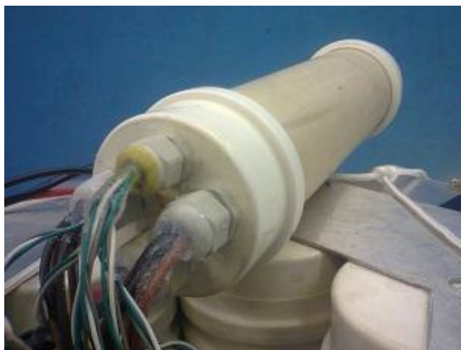
Figura 6-7 Foto do tubo de encapsulamento do sistema eletrônico após construção
