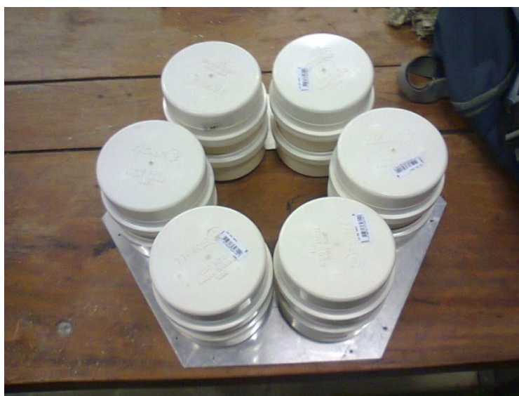
Figura 5-8 Foto do sistema de flutuação montado no topo do veículo
