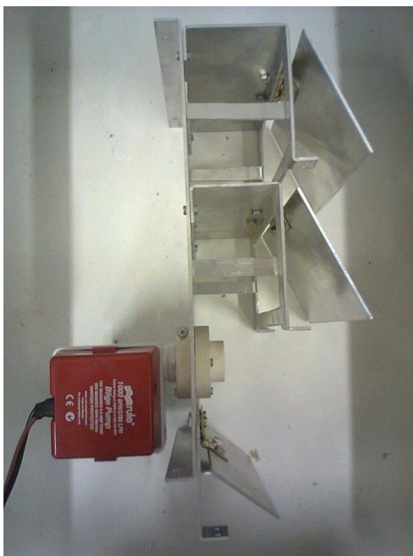
Figura 10-16 Parede do veículo com bases dos sensores e bomba com bocal
